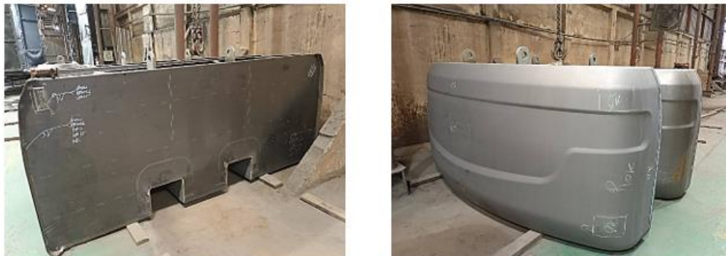
ภาพที่ 12 ตัวถ่วง (Counterweight) ที่สำเร็จแล้วหลังจากผ่านขั้นตอนทำงานเชื่อม
