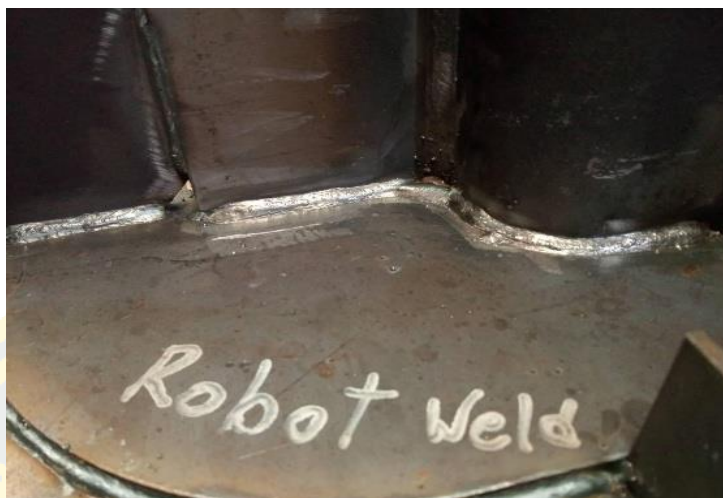
ภาพที่ 17 แนวเชื่อมโดยใช้ Robot weld
