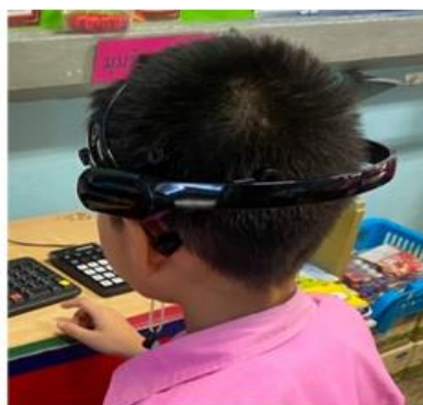
ภาพที่ 60 ติดตั้งอุปกรณ์การวัดคลื่นไฟฟ้าสมองบนศีรษะผู้เข้าร่วมทดลอง
