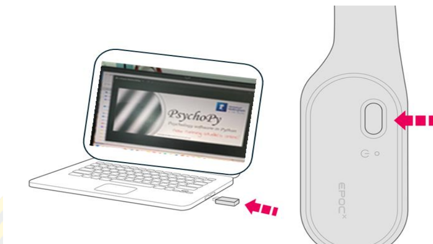
ภาพที่ 59 การเชื่อมต่อ อุปกรณ์การวัดคลื่นไฟฟ้าสมอง
