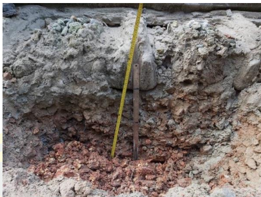
ภาพที่ 23 ลักษณะการเก็บตัวอย่างหินโรยทางในจุดที่มีการปนเปื้อนสูง
