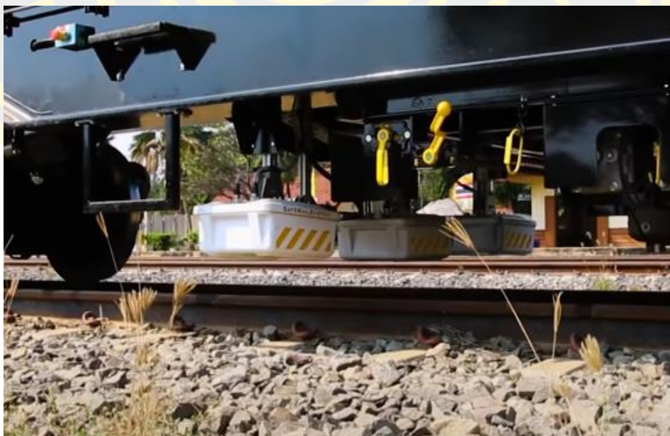
ภาพที่ 20 การติดตั้งเครื่องมือ GPR สำหรับการสำรวจสภาพทาง
