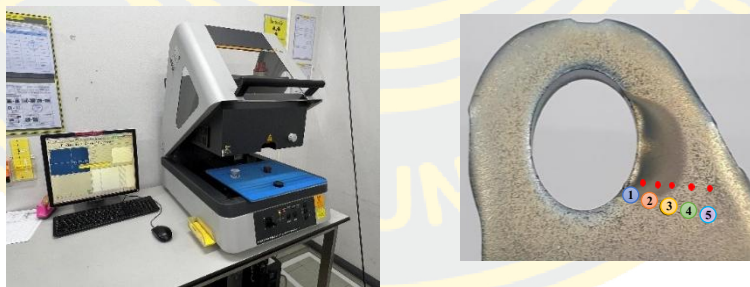
ภาพที่ 23 การวัดความหนาของผิวชุบบริเวณที่เกิดปัญหา
