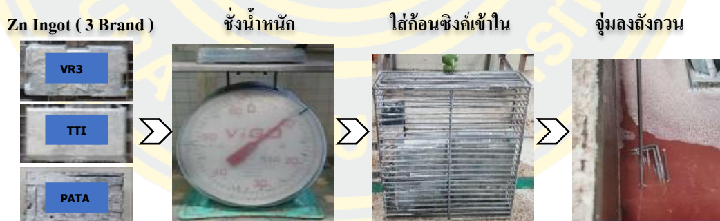
ภาพที่ 29 วิธีการทดลองเปรียบเทียบอัตราการละลายของก้อนซิงค์แต่ละแบรนด์
