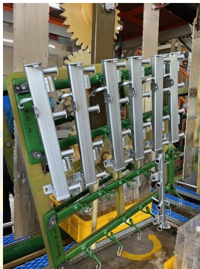
ภาพที่ 11 การจัดเรียงชิ้นงานกระบวนการชุบซิงค์ นิกเกิล
