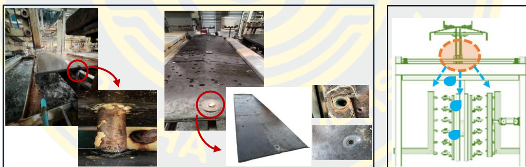
ภาพที่ 25 การกั้ดร้อนน้อดย้ดบนหลังคา Hanger (ซ้ายมือ) และ ภาพจำลองการหยดน้ำยา(ขวามือ)
