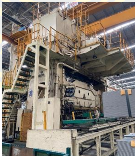
ภาพที่ 11 เครื่อง Stamping Process ขนาด 3,000 ตัน
