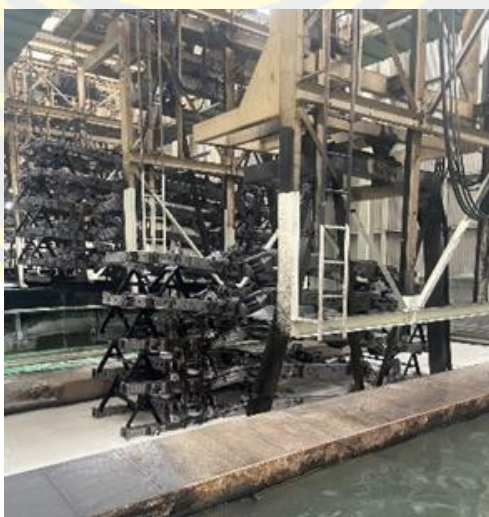
ภาพที่ 13 กระบวนการชุบสีของ Chassis Frame
