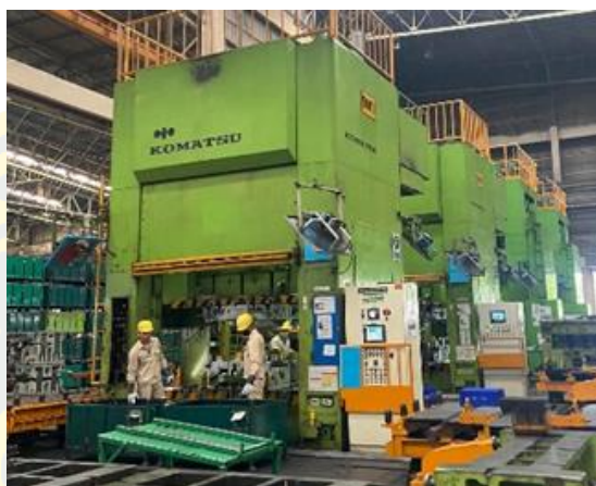
ภาพที่ 16 เครื่อง Stamping Process ขนาด 2,000 ตัน
