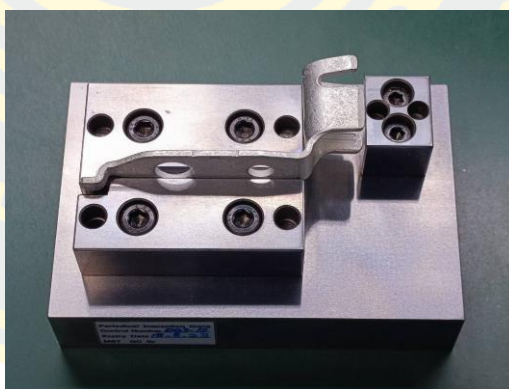
ภาพที่ 16 ชิ้นงานสวมลงได้ไม่หมดยังมีส่วนที่ติดอยู่บนจิ๊ก 2 ใน 3 ส่วน
