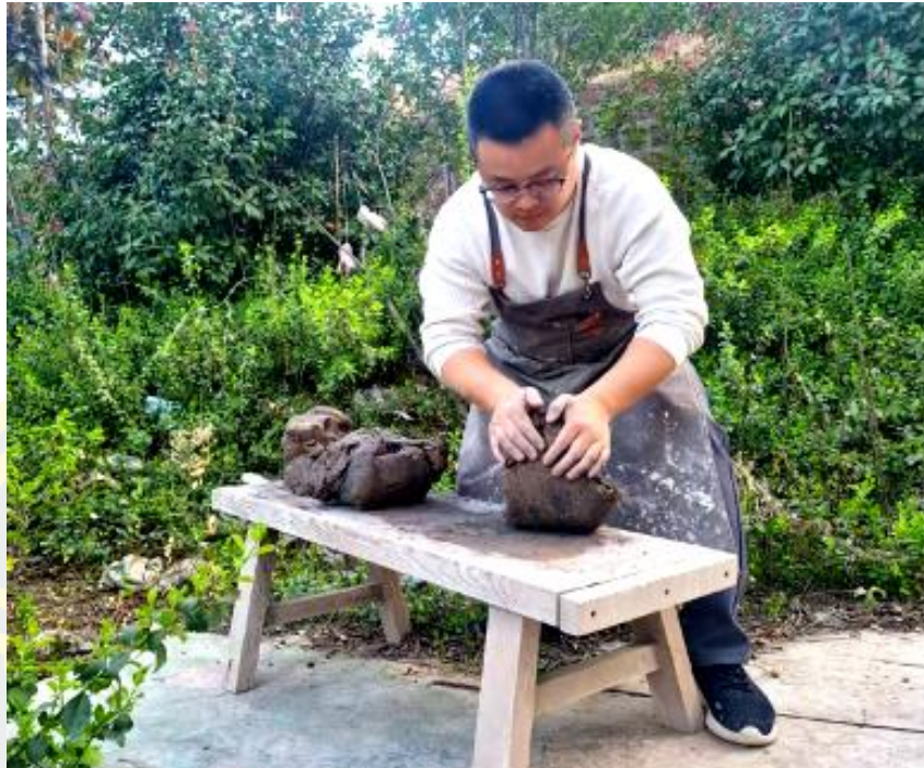
ภาพที่ 3-29 การนวดโคลน (ถ่ายโดยผู้วิจัย)
