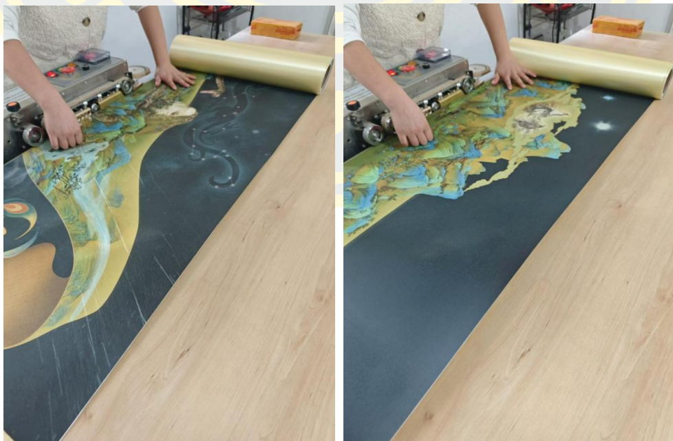
ภาพที่ 3-54 การผนึกขอบด้วยความร้อนสูง (Wu Siwei, 2024)
