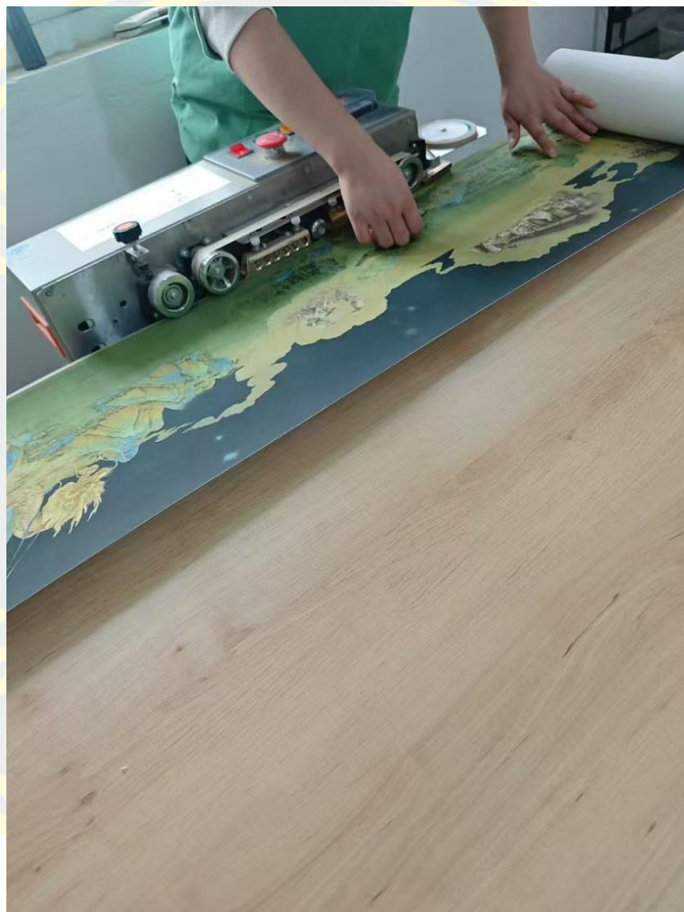
ภาพที่ 3-38 การผนึกขอบด้วยความร้อนสูง (Wu Siwei, 2024)
