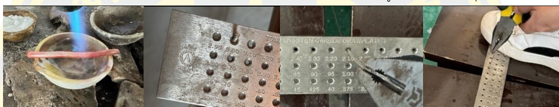
20. การทำซ้ำชั้น การหลอม และการวาดลวด
