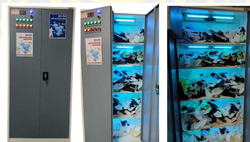
ภาพที่ 37 การฆ่าเชื้อน้ำกากอเนมัยที่ใช้แล้วด้วยกระบวนการ AOP
