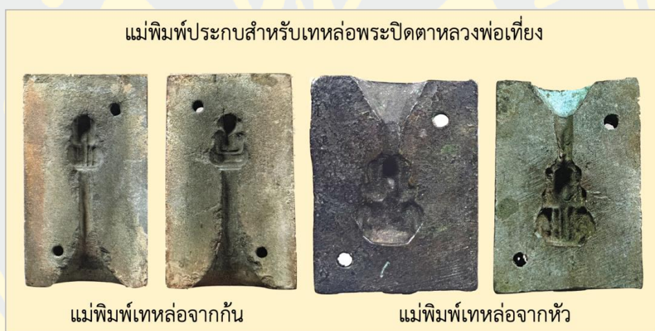
ภาพที่ 21 แม่พิมพ์แบบประกบสำหรับเทหล่อพระปิดตาหลวงพ่อเทียงเนื้อตะกั่วผสมปรอท ที่มา : เอกพล ศุขตระกูล (2557)
