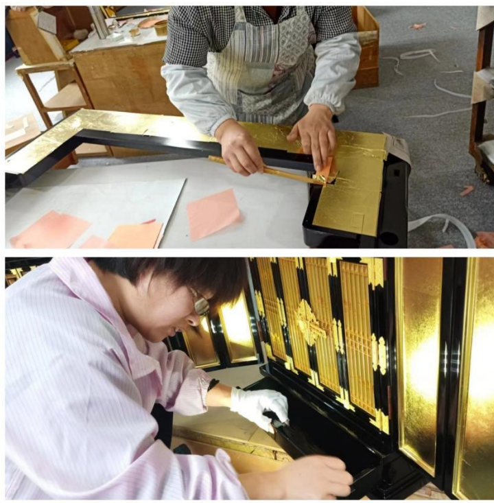
ภาพที่ 3-32 กระบวนการปิดทอง (Ji Zhou, 2023)
