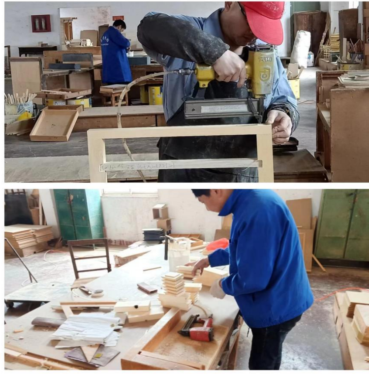
ภาพที่ 3-29 กระบวนการประกอบและยึดชิ้นส่วนงานไม้เพื่อสร้างโครงกรอบซึ่งเป็นโครงสร้างหลักของตัวแท่นบูชา (Ji Zhou, 2023)
