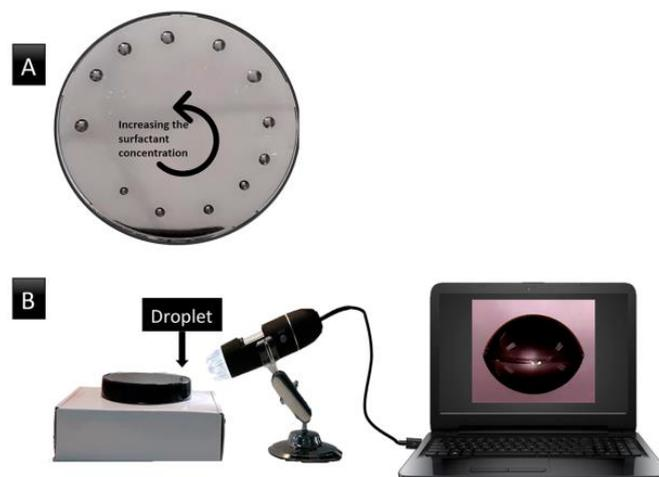
ภาพที่ 31 (A) มุมมองจากด้านบนของจานเพาะเชื้อที่มีการหยดสารละลายเซทิลไตรเมทิลแอมโมเนียมโบรไมด์ (10 ไมโครลิตรต่อหยด) ซึ่งมีความเข้มข้นเพิ่มขึ้น (B) การตั้งค่าการถ่ายภาพโดยใช้กล้องจุลทรรศน์ USB ที่มีต้นทุนต่ำ แสดงให้เห็นการจัดตำแหน่งของเลนส์กับหยดสารที่ถูกนำมาใช้
