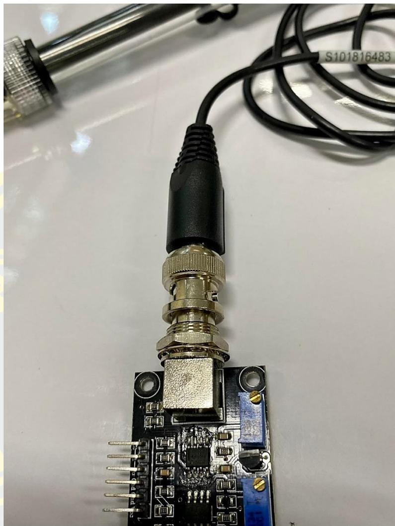
รูปที่ 3.29 การเชื่อมต่อ pH sensor probe ผ่าน BNC port บน pH meter module
