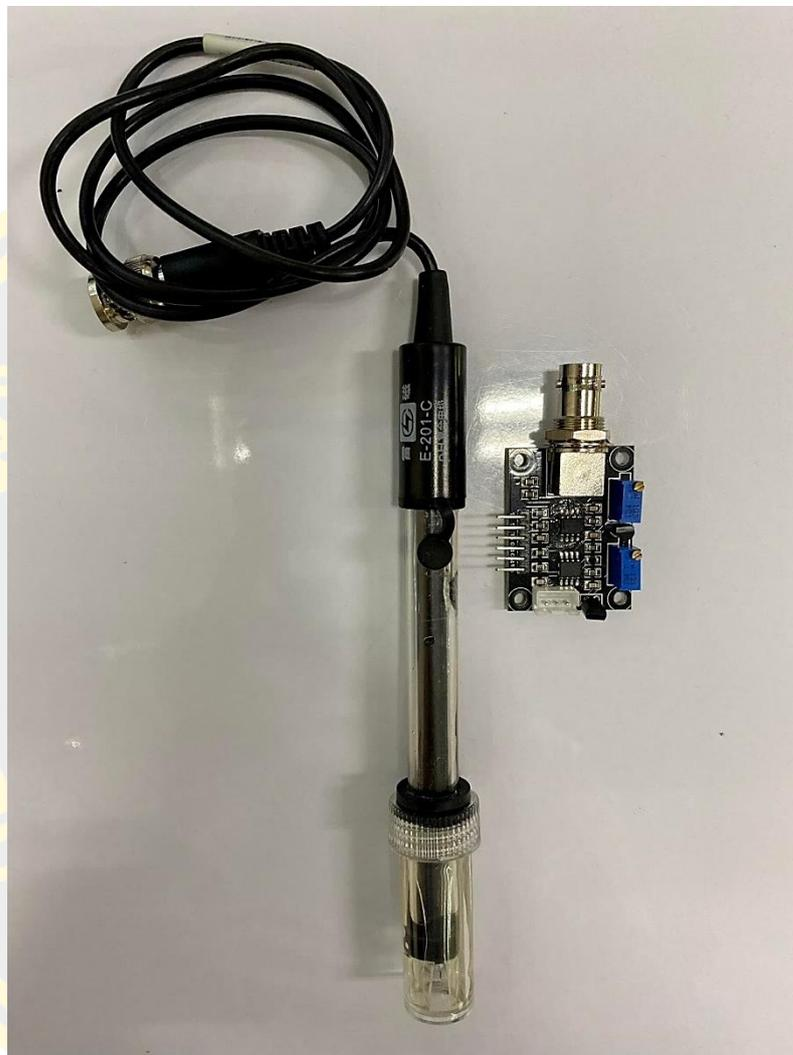
รูปที่ 3.28 อุปกรณ์วัดค่าความเป็นกรด-ด่าง รุ่น E-201-C
