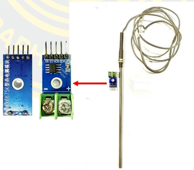
รูปที่ 3.35 อุปกรณ์วัดอุณหภูมิ K-Type Thermocouple รุ่น MAX6675
