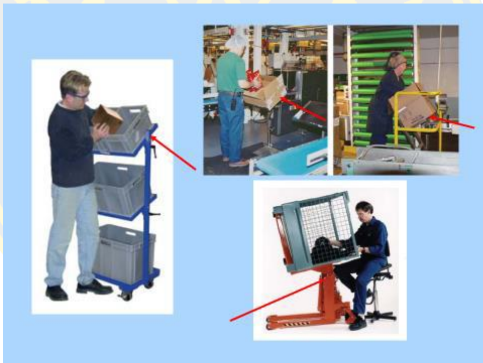
ภาพที่ 8 ใช้อุปกรณ์ช่วยปรับมุมวางของภาชนะเพื่อให้หยิบวัสดุได้สะดวก
