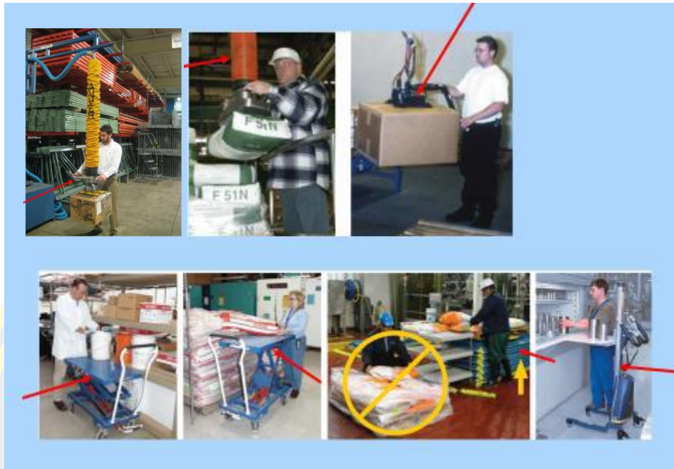
ภาพที่ 9 ใช้อุปกรณ์ช่วยในการยกและเคลื่อนย้ายวัสดุ
