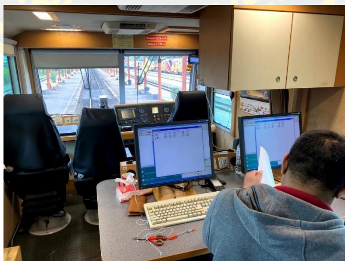
ภาพที่ 2-23 ห้องควบคุมและอุปกรณ์บันทึกข้อมูล ภายในรถ EM120
