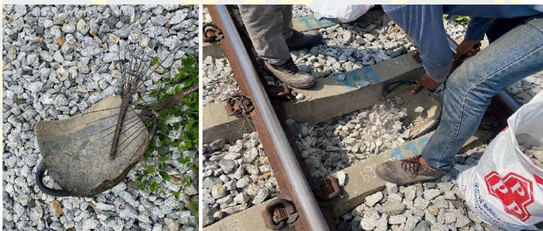
ภาพที่ 3-6 อุปกรณ์และภาพขณะกำลังการเก็บตัวอย่างหินโรยทาง
