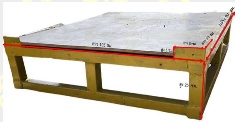
ภาพที่ 19 อุปกรณ์โต๊ะเหล็กฐานรองเพิ่มความสูง 25 เซนติเมตร ที่มา: ศรัณยู ค่ำกลาง (8 พฤษภาคม 2566)
