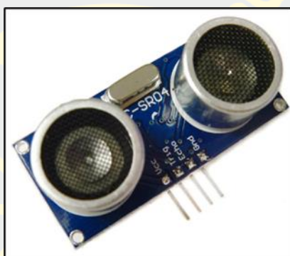
ภาพที่ 9 เซนเซอร์อัลตราโซนิก HC-SR04 (RobotSiam, 2559)
