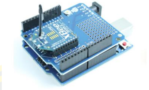
ภาพที่ 7 แผงควบคุม Arduino ต่อกับแผงควบคุม XBee Shield (Thaieasyelec, 2560)
