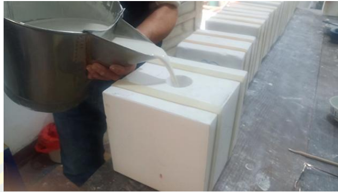
ภาพที่ 4-32 การหล่อน้ำดิน (Li Bailu, 2023)
