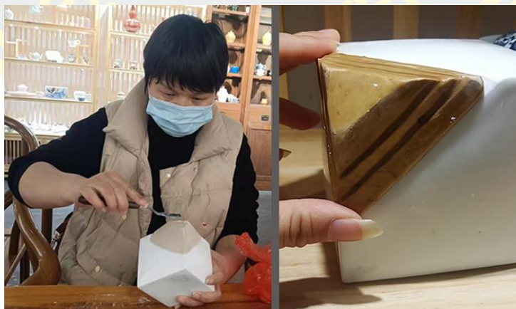
ภาพที่ 4-34 การเจียรส่วนฐาน (Li Bailu, 2023)
