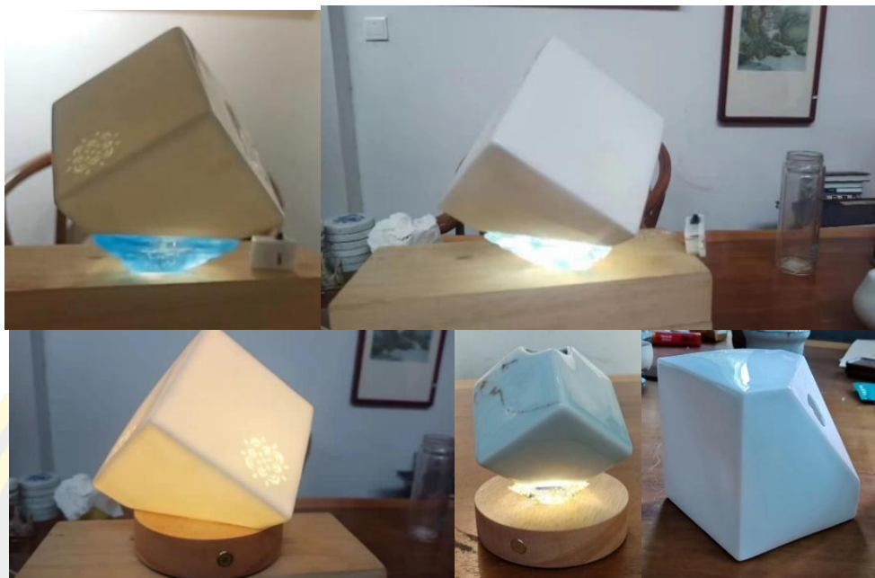
ภาพที่ 4-35 การทดลองประกอบดวงไฟและตัวโคมไฟกลางคืน (Li Bailu, 2023)
