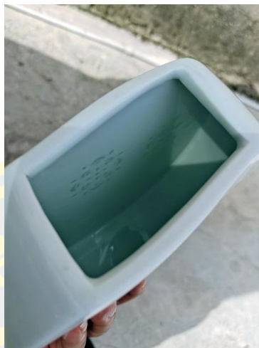
ภาพที่ 5-14 ผลิตภัณฑ์หลังเผาที่เสียรูปทรง (Li Bailu, 2023)
