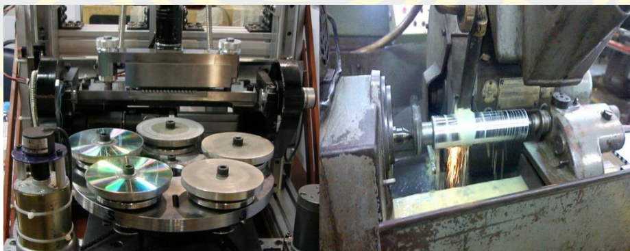
ภาพที่ 8 วิธีการทำพลอยโดยใช้เครื่องจักรจะได้ในจำนวนมาก แต่ไม่มีความละเอียดเพราะใช้ ระบบควบคุม
