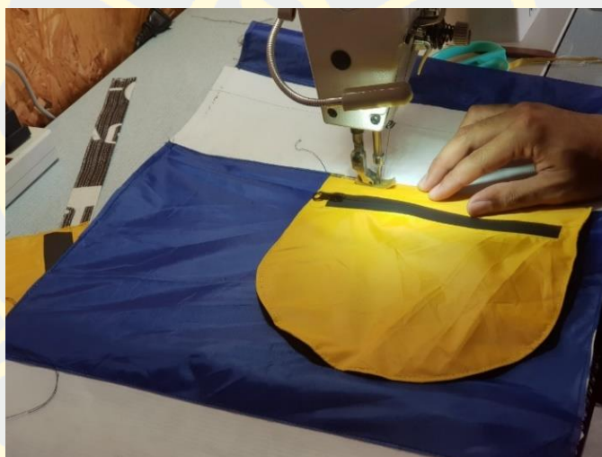
ภาพที่ 4-96 เย็บกระเป๋าด้านหน้าเข้ากับโครงสร้างกระเป๋า (ช่องใส่ของเล็ก)
