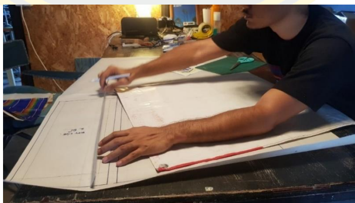
ภาพที่ 4-19 วัดสัดส่วนจากแบบร่างตัดส่วนป้ายโฆษณาไวนิลที่ใช้แล้วส่วนโครงสร้าง (1)
