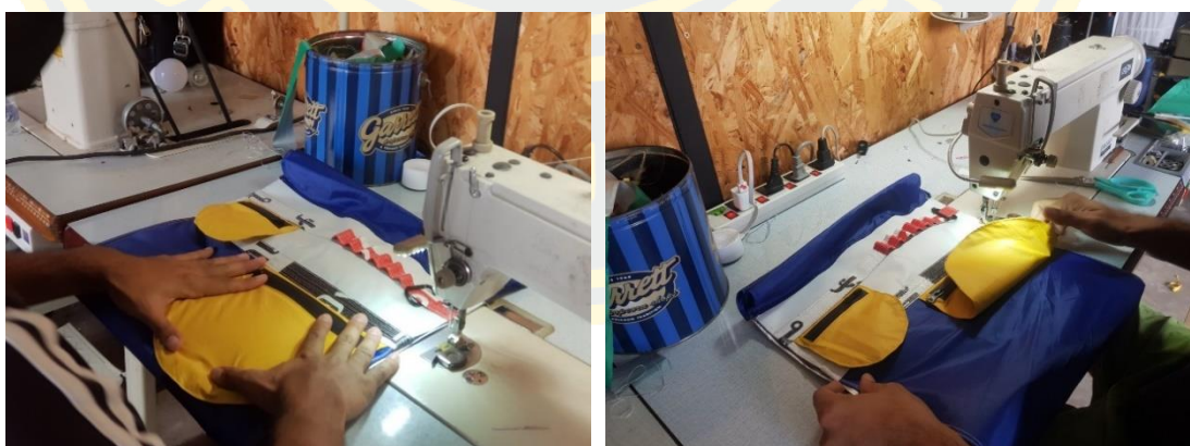
ภาพที่ 4-99 เย็บด้านข้างของโครงสร้างกระเป๋ (ประกอบ โครงสร้างกระเป๋)
