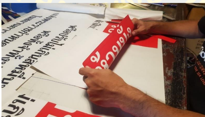
ภาพที่ 4-24 ตัดวัสดุป้ายไว้นิลตามสัดส่วนที่วัดจากแบบร่างส่วนเสริมฐาน
