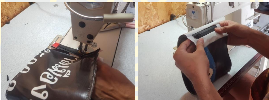
ภาพที่ 4-67 เย็บซิปสำหรับช่องใส่ของด้านใน
