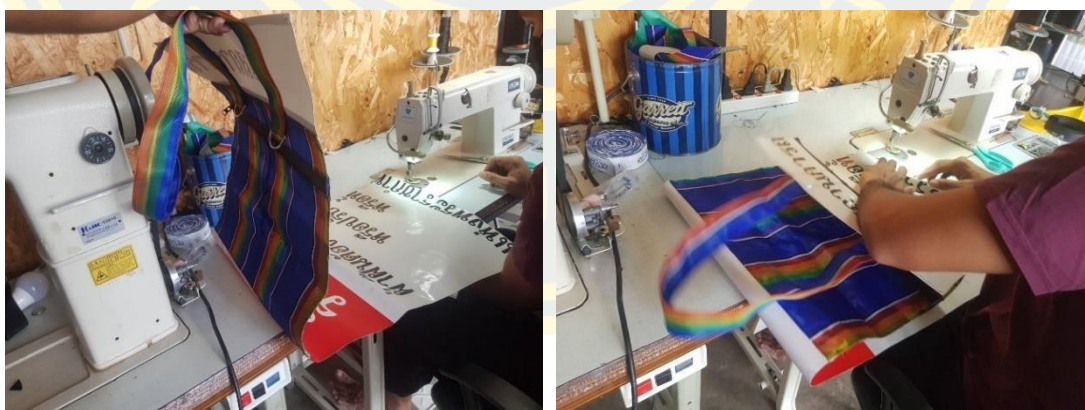
ภาพที่ 4-39 เย็บโครงสร้างส่วนกันและด้านหลัง
