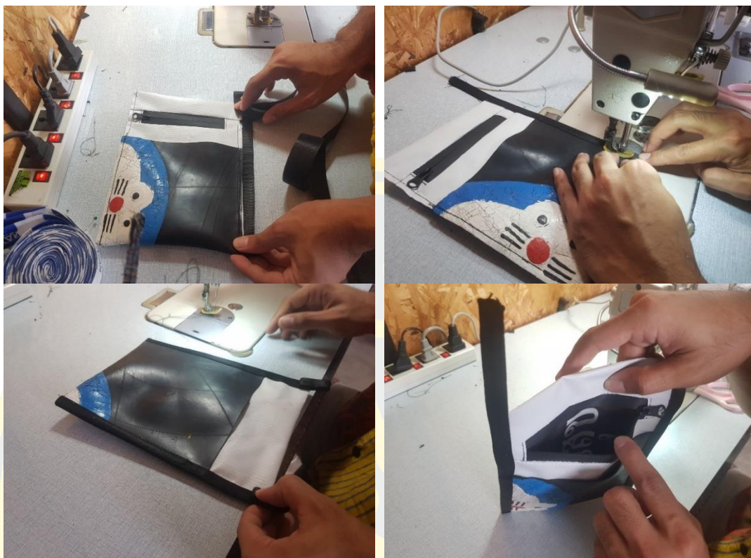
ภาพที่ 4-68 เย็บขอบด้านข้าง (ก้นขอบ)
