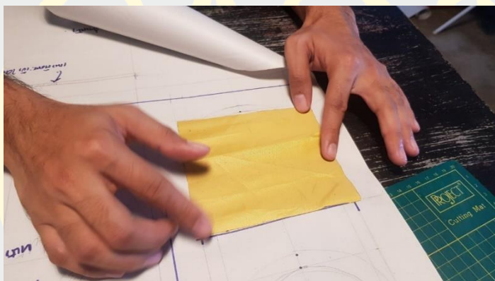
ภาพที่ 4-84 ตัดวัสดุผ้าร่มตามสัดส่วนที่วัดจากแบบร่างส่วนช่องใส่ของเด็ก
