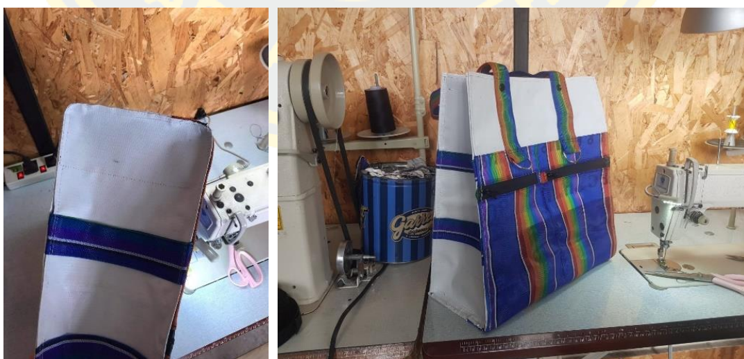
ภาพที่ 4-44 เย็บด้านข้างเข้ากับ โครงสร้าง
