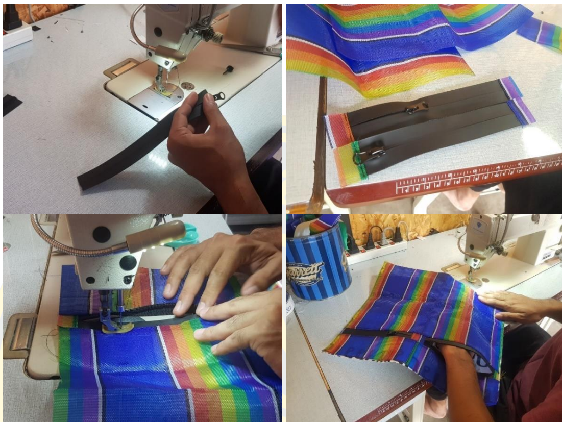
ภาพที่ 4-35 เย็บซิปเข้ากับผ้าไนลอน (ช่องใส่ของด้านหน้า)
