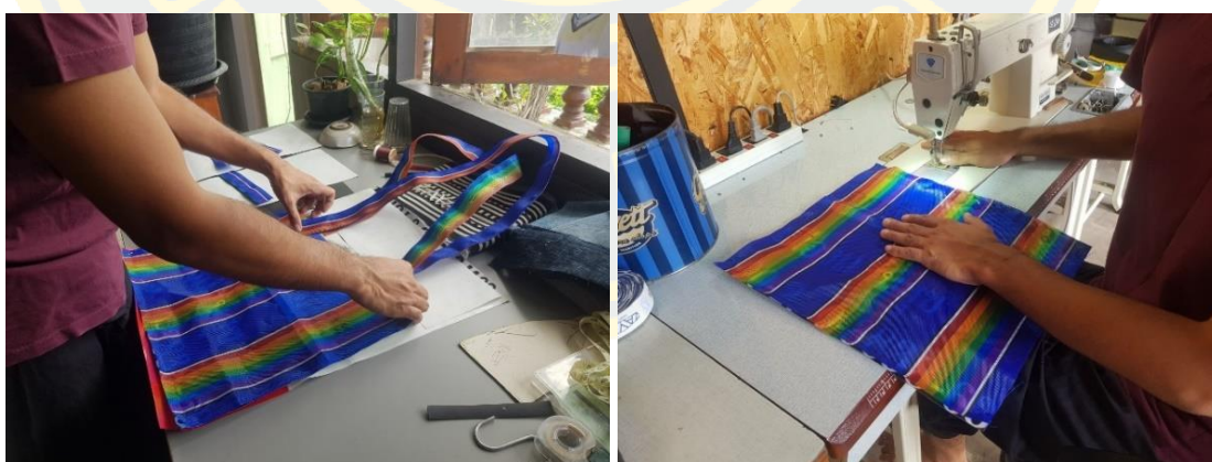
ภาพที่ 4-34 เย็บผ้าไนลอนเข้ากับผ้าไวไนล
