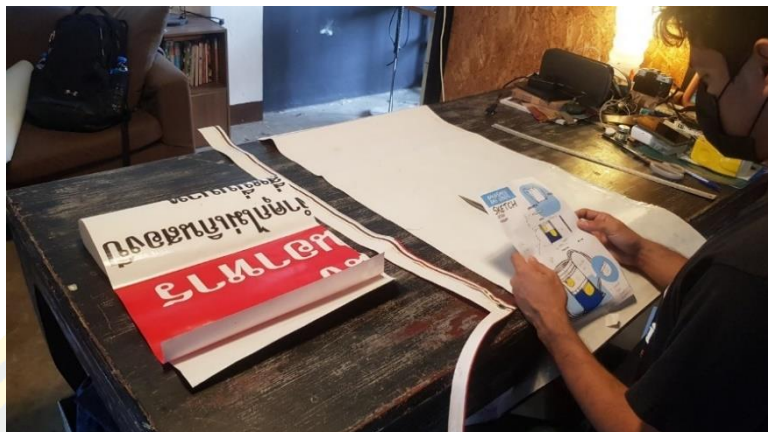
ภาพที่ 4-81 ตัดวัสดุป้ายไวนิลตามสัดส่วนที่วัดจากแบบร่างส่วน โครงสร้าง (3)
