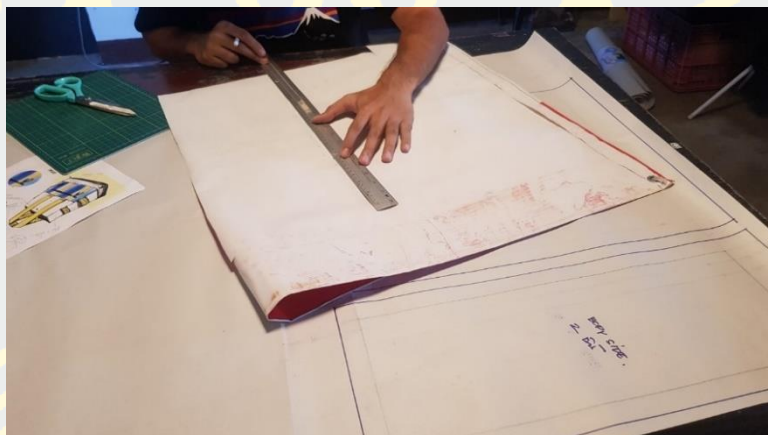
ภาพที่ 4-21 ตัดวัสดุป้ายไวเนลตามสัดส่วนที่วัดจากแบบร่างส่วนโครงสร้าง (1)
