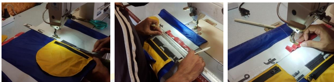
ภาพที่ 4-97 เย็บช่องเสียบของด้านหน้าเข้ากับโครงสร้างกระเป๋ (ช่องเสียบของ)
