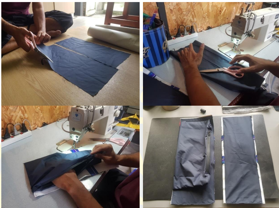
ภาพที่ 4-38 ตัดเย็บกระเป๋าด้านในส่วนซบในด้านข้าง
