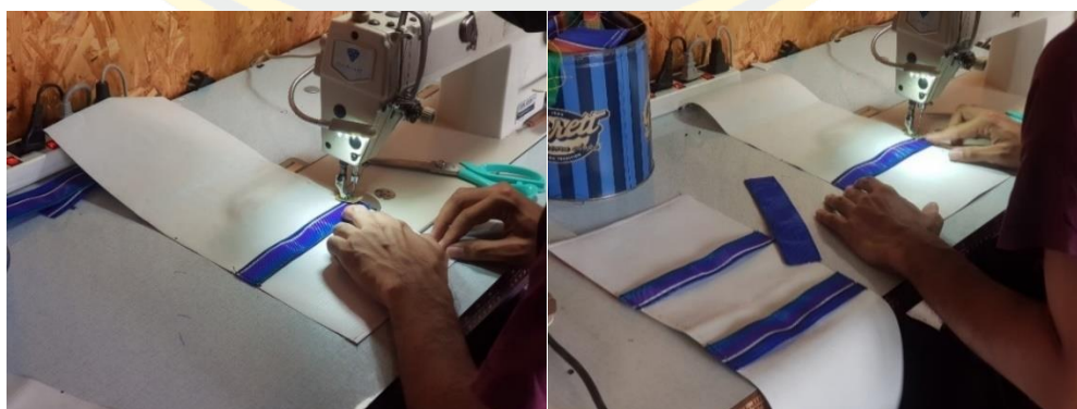
ภาพที่ 4-37 เย็บสายรัดด้านข้าง
