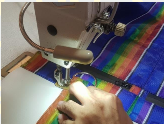
ภาพที่ 4-41 ติดตั้งหูลโลหะสำหรับแขวนในส่วนสายสะพายด้านข้าง
