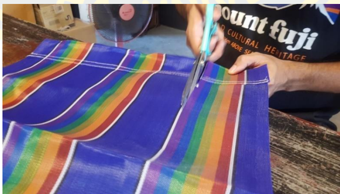
ภาพที่ 4-30 ตัดวัสดุผ้าไนลอนตามสัดส่วนที่วัดจากแบบร่างส่วนสายคาดด้านข้าง
