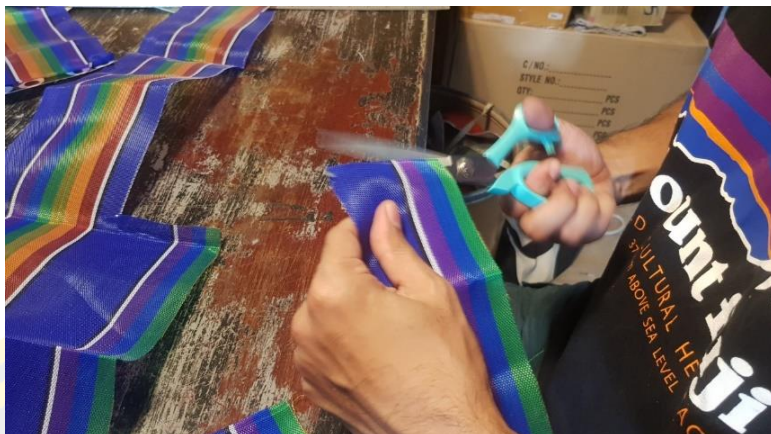
ภาพที่ 4-28 ตัดวัสดุผ้าไนลอนตามสัดส่วนที่วัดจากแบบร่างส่วนสายสะพาย
