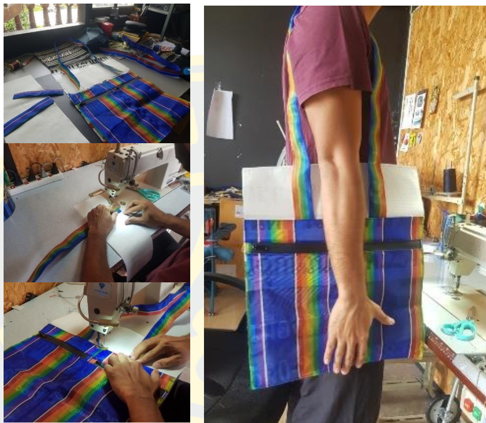
ภาพที่ 4-36 เย็บผ้าไวเนิลส่วนด้านบนสำหรับติดตั้งสายสะพายด้านหน้า
