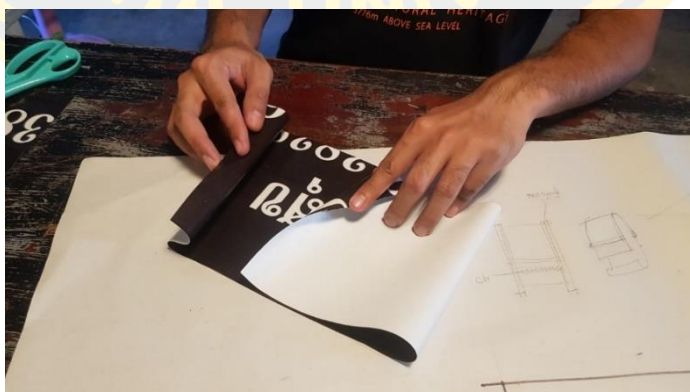
ภาพที่ 4-60 ตัดวัสดุป้ายไวนิลตามสัดส่วนที่วัดจากแบบร่างส่วน โครงสร้าง (3)
