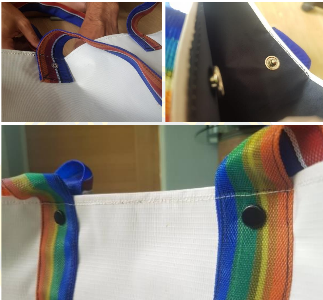
ภาพที่ 4-45 ติดตั้งหมุดตรงช่องใส่ของด้านบน
