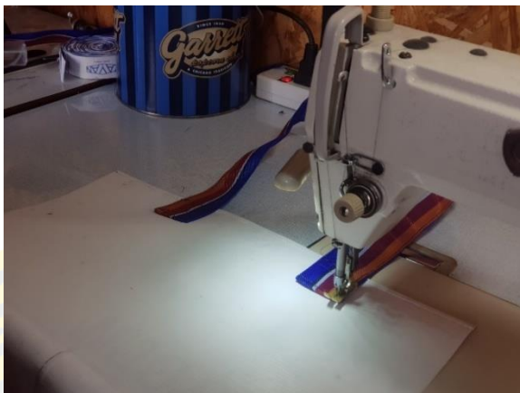
ภาพที่ 4-40 เย็บสายสะพายด้านหลัง
