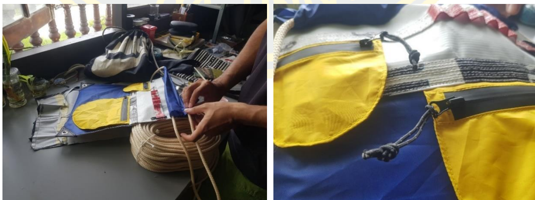
ภาพที่ 4-102 ใส่เชือกสำหรับสะพายและเชือกหุซิปช่องใส่ของด้านหน้า
