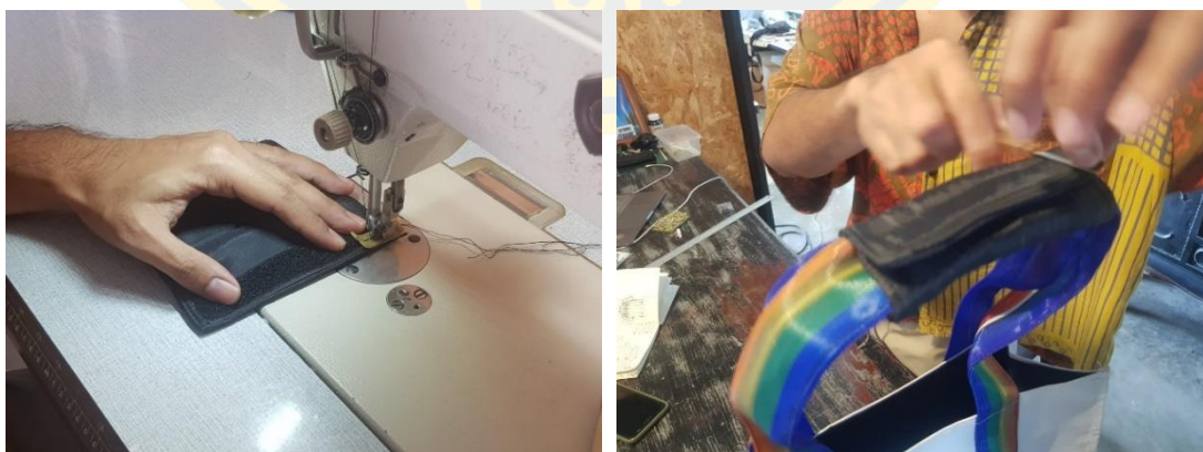
ภาพที่ 4-46 เช็บสายรัดสายสะพาย
