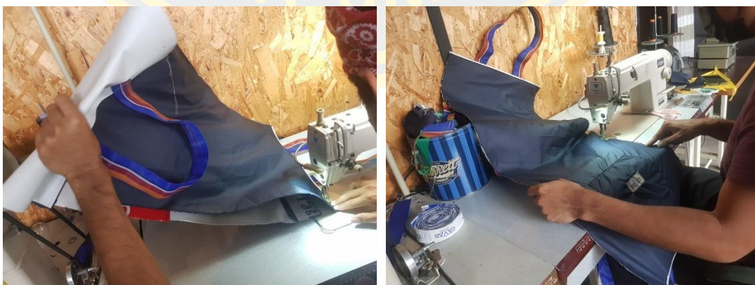
ภาพที่ 4-42 เย็บชั้นในและช่องใส่ของด้านในโครงสร้างกระเป๋า (1)
