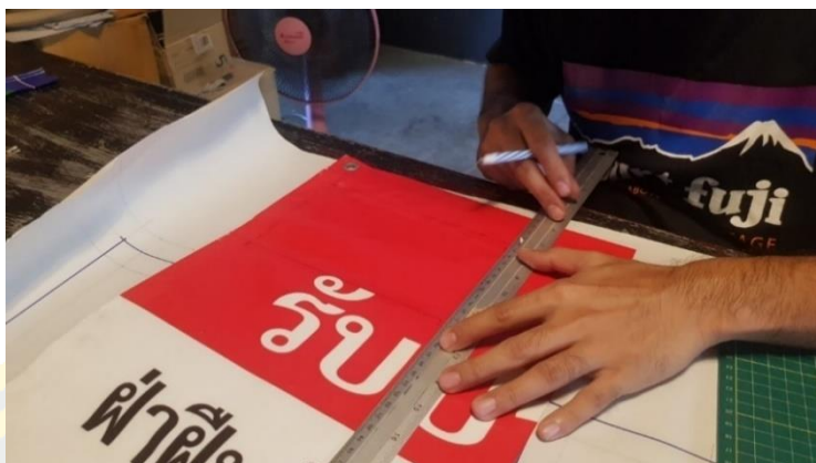
ภาพที่ 4-22 ตัดวัสดุป้ายไว้นิลตามสัดส่วนที่วัดจากแบบร่างส่วน โครงสร้าง (2)
