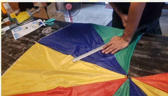
ภาพที่ 4-82 ตัดวัสดุฟุ้งตามสัดส่วนที่วัดจากแบบร่างส่วนด้านหน้า
