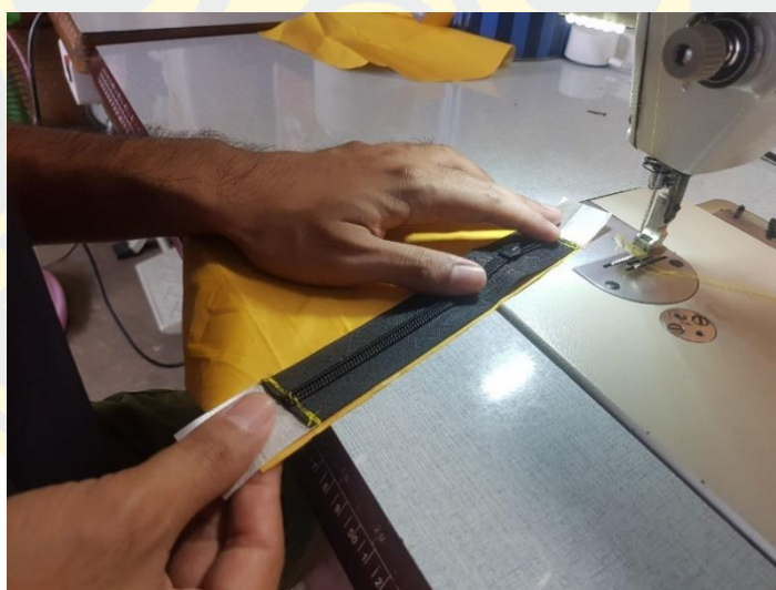
ภาพที่ 4-92 เย็บซิปลช่องใส่ของด้านหน้า
