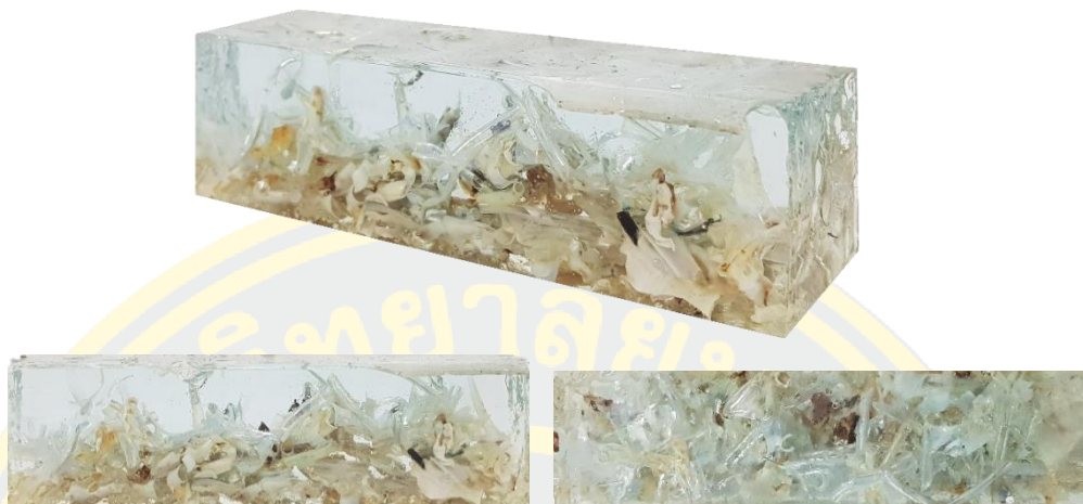
ภาพที่ 66 ปริมาณเศษขวดน้ำพลาสติกครึ่งหนึ่งต่อการหล่อเรซินขึ้นรูป
