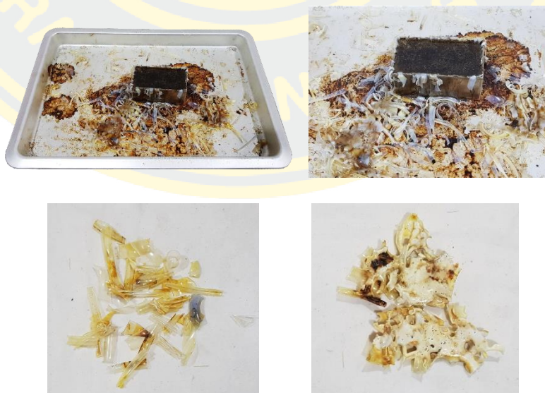
ภาพที่ 63 เศษขวดน้ำพลาสติกที่ล้นออกจากแม่พิมพ์ขณะหลอม
