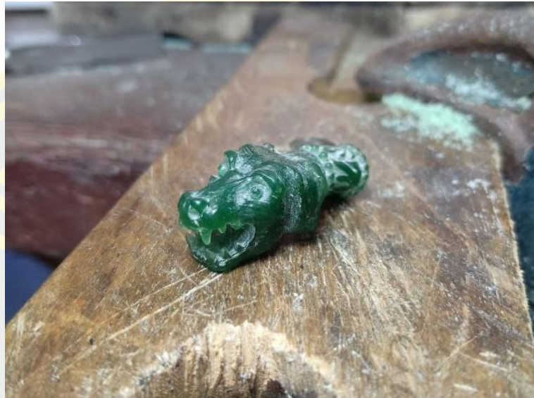
ภาพที่ 4-22 ต้นแบบผลิตภัณฑ์ขึ้นรูปโดยการแกะสลักด้วยมือ (แว็กซ์)
