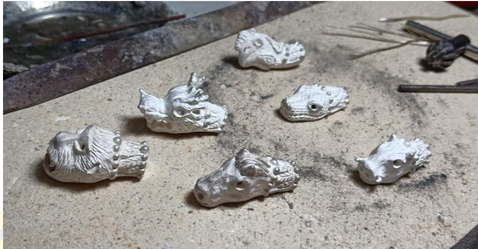
ภาพที่ 4-25 ชิ้นงานหลังจากตัดออกจากต้นเทียน
