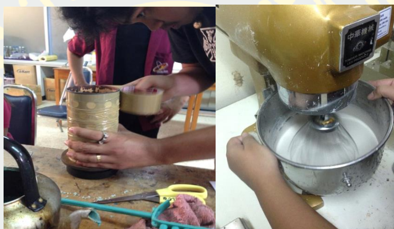
ภาพที่ 4-24 พันสก็อตเทปที่กระบอกและผสมปูนทำบล็อก
