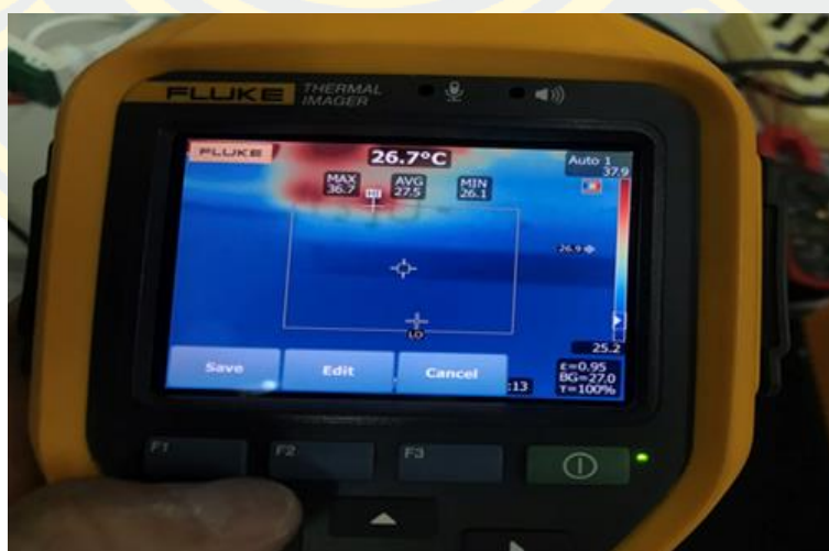
ภาพที่ 22 อุณหภูมิที่ใช้ในการเปลี่ยนสีของสติกเกอร์เทอร์โมโครมิก ที่มา : ยืนยง เพียรสวัสดิ์ (วันที่ 18 กันยายน พ.ศ. 2564)
