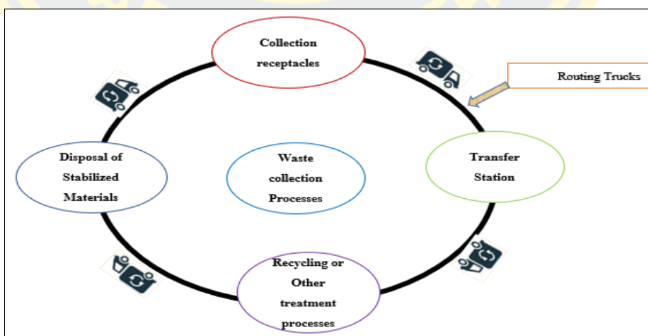
ภาพที่ 3 กระบวนการรวบรวม และขนส่งขยะมูลฝอย ที่มา: (Sulemana et al., 2018)
