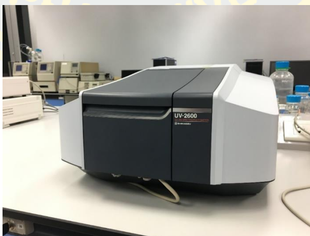
ภาพที่ 20 เครื่อง UV-Visible Spectrophotometer
