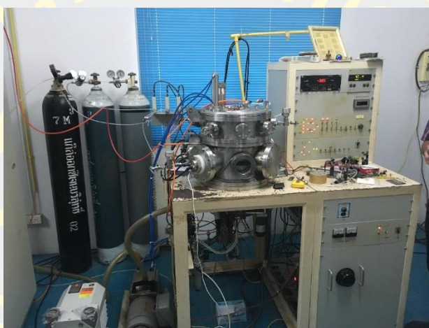
ภาพที่ 19 เครื่องเคลือบฟิล์มบางระบบรีแอกติฟ อันบาลานซ์ แมกนีตรอน สปีดเทอริง ที่ใช้ใน งานวิจัย
