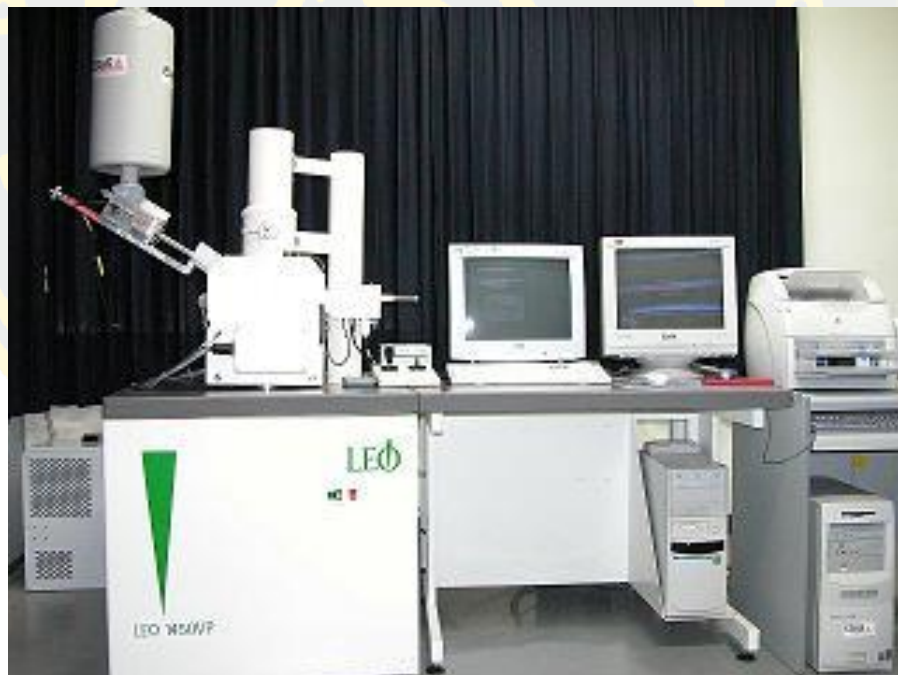
ภาพที่ 22 เครื่อง Scanning Electron Microscope (SEM) และ Energy Dispersive X-ray Spectroscopy (EDX)
