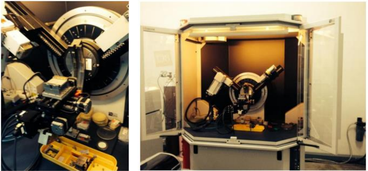
ภาพที่ 21 เครื่อง X-ray Diffractometer (XRD)
