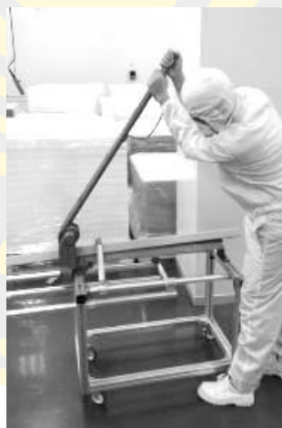
ภาพที่ 22 เครื่องตัดแกนกระดาษพร้อมแท่นวาง ที่มา: โรงงานผลิตพลาสติกแห่งหนึ่งในจังหวัดระยอง (2019)
