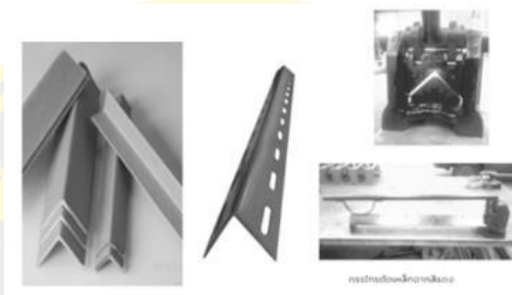
ภาพที่ 21 แกนกระดาษเปรียบเทียบกับเหล็กฉากและเครื่องตัดเหล็กฉาก ที่มา: โรงงานผลิตพลาสติกแห่งหนึ่งในจังหวัดระยอง (2019)
