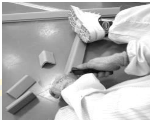
ภาพที่ 8 งานตัดแกนกระดาษแข็งสำหรับกันชนข้างกล่อง ที่มา: โรงงานผลิตพลาสติกแห่งหนึ่งในจังหวัดระยอง (2019)
