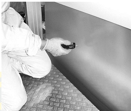
ภาพที่ 5 งานตัดไล่ฟองอากาศในชั้นฟิล์มเคลือบผิวออก ที่มา: โรงงานผลิตพลาสติกแห่งหนึ่งในจังหวัดระยอง (2019)
