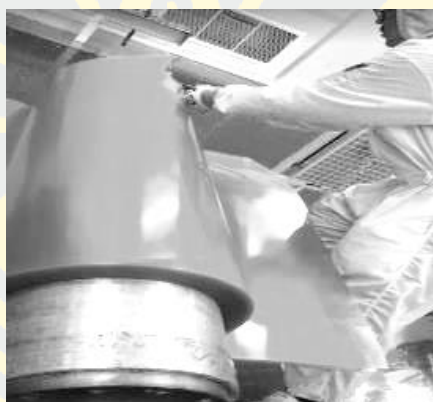
ภาพที่ 6 งานกรีดทำลายม้วนฟิล์มที่ไม่ผ่านการทดสอบคุณภาพ ที่มา: โรงงานผลิตพลาสติกแห่งหนึ่งในจังหวัดระยอง (2019)
