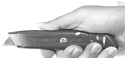
ภาพที่ 15 มีดแบบทั่วไปไม่มีระบบดึงใบมีดกลับอัตโนมัติ ที่มา: โรงงานผลิตแผ่นฟิล์มพลาสติกแห่งหนึ่งในจังหวัดระยอง (2019)
