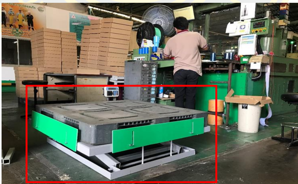
ภาพที่ 19 การติดตั้งอุปกรณ์ช่วยที่สามารถปรับระดับความสูงของการวางพาเลท
