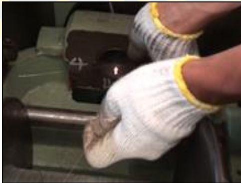
ภาพที่ 18 ขั้นตอนของการใส่ลวดที่อยู่ใน (Bobbin) เข้ามาใส่ในตัวเครื่อง
