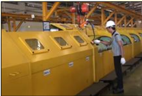
ภาพที่ 17 ขั้นตอนเตรียมกระสวย (Bobbin) ลวด เข้าเครื่อง TUBULAR
