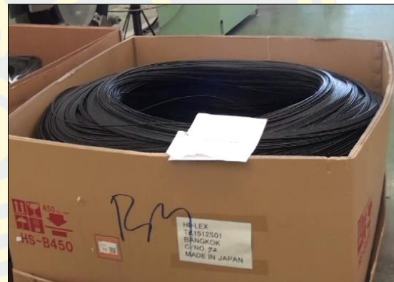
ภาพที่ 22 ขั้นตอนการนำดิ่ง Outer shield ผ่านเครื่อง Take off เพื่อจัดเก็บ Outer เข้ากล่องเพื่อรอส่ง กระบวนการถัดไป
