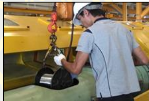
ภาพที่ 17 ขั้นตอนเตรียมกระสวย (Bobbin) ลวด เข้าเครื่อง TUBULAR
