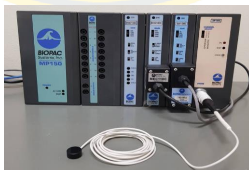
ภาพที่ 9 เครื่อง Biopac และ เซนเซอร์ของ Blood flow transducer เป็นเครื่องมือวัดการไหลเวียนของเลือด (Blood flow)
